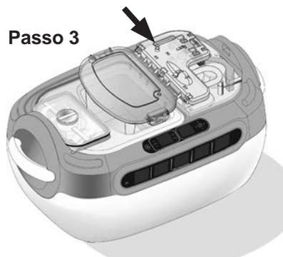
4. Aprire la testa della pompa ed allungare i tubi sulla ruota.
